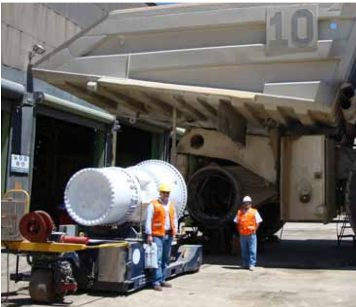
VWT XC20 con el Wheel Motor universal de gran tamaño
